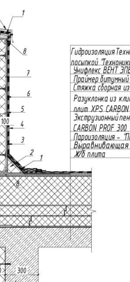
Узел примыкания кровли к парапету М 1:20
