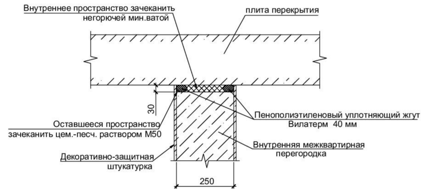
Узел примыкания внутренней межквартирной перегородки к перекрытию
